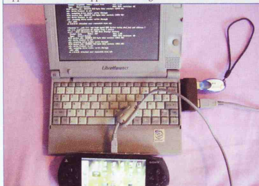
Figure 1 : Connexion de la PSP à un ordinateur portable sous Debian GNU/Linux sur lequel est installé le PSP SDK : la console apparaît comme un support de stockage de masse sur le bus USB.
